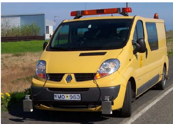
Mynd 3 Tvö leysimælibox yfir hvoru hjólfari
