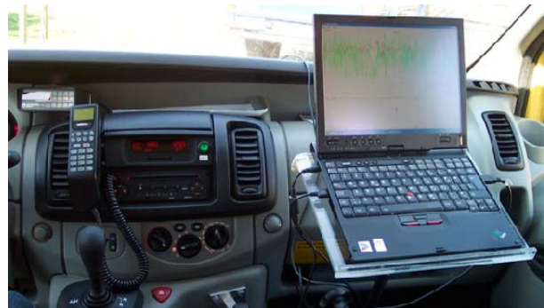
Mynd 5 Fartölva með mæliforriti ethernet- / cat5- tengd miðeiningu
