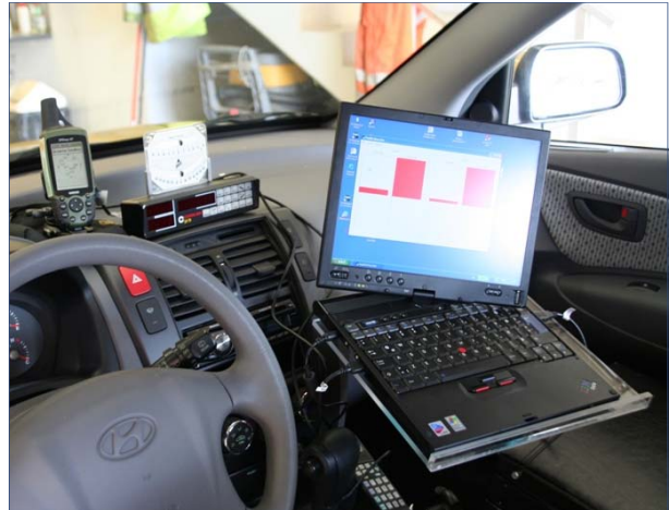
Mynd 8 Mæliforrit, Profile Recorder og tölva í Hyundai bíl á e-deildar, sem notaður var við mælingar 2006 og 2007
